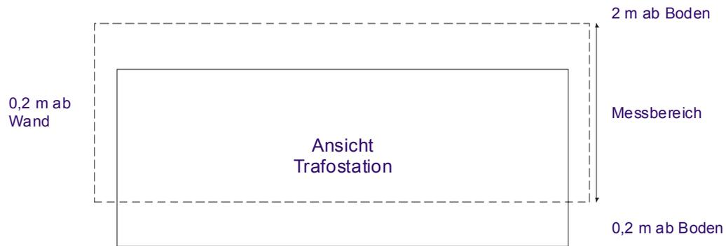
**Abb. 3.1.-2** Grenzliniendarstellung einer Netzstation kleiner 2 m für die Seitenansicht
